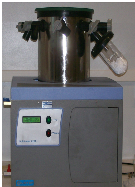
Figura 7- Liofilizador Liotop L202 com amostra da HAP.
