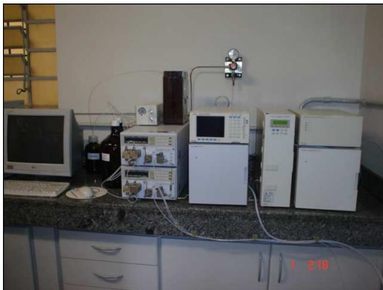
Figura 14 - Cromatógrafo Shimadzu ODS-A utilizado para CLAE. (Foto de A. G. L. Cardozo, 2007)
