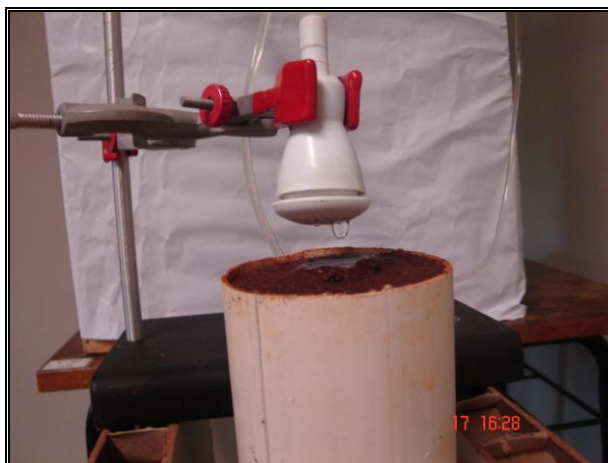
FIGURA 10: Água de xisto gotejando na coluna de solo Fonte: autoria própria, 2008
