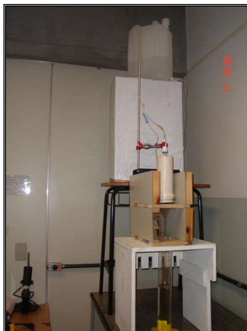
FIGURA 11: Frasco de Mariotte (no alto), alimentando a coluna de solo com água de xisto diluída 50 vezes. Fonte: Autoria própria, 2008
