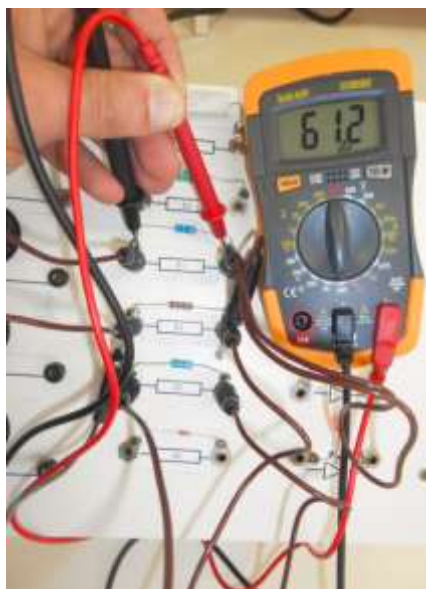
Figura 45: Medição de resistência equivalente. Fonte: O autor.
