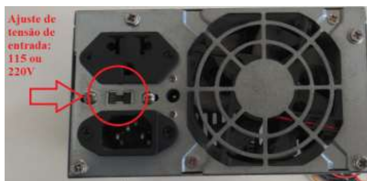
Figura 168: seleção da tensão de entrada da fonte. Fonte: O autor.
