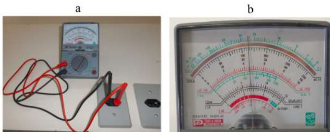
Figura 75: (a) multímetro analógico sendo utilizado para medir tensão alternada. (b) Detalhe da escala. Fonte: o autor.
