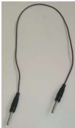
Figura 25: cabos com plugue tipo pino banana. Fonte: O autor.
