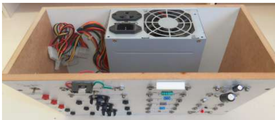
Figura 72: Fonte ATX adaptada ao painel didático. Fonte: O autor.
