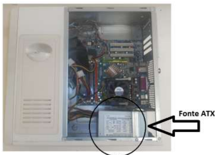
Figura 30: Imagem da CPU de computador com destaque para a fonte ATX. Fonte: O autor.
