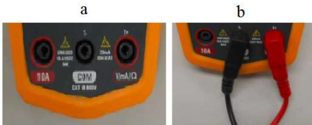
Figura 80: (a) foto dos bornes de um multímetro digital. (b) Pontas de prova inseridas nos bornes do multímetro. Fonte: o autor.
