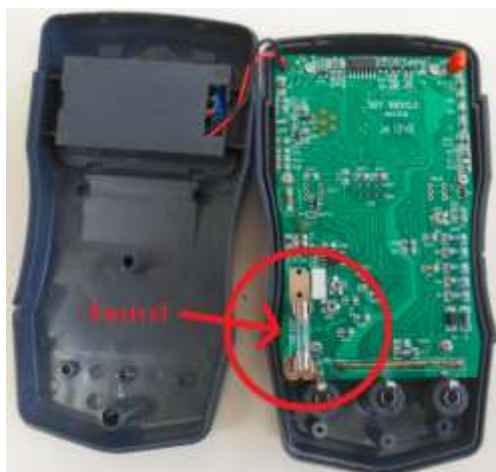
Figura 82: foto do multímetro aberto onde pode ser visualizado o fusível interno. Fonte: o autor.
