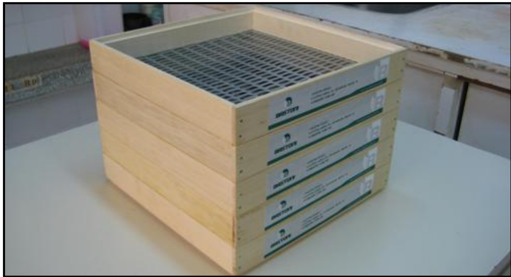
Figura 1. Peneiras usadas para a classificação das sementes de feijão, cultivar IPR Tangará.
