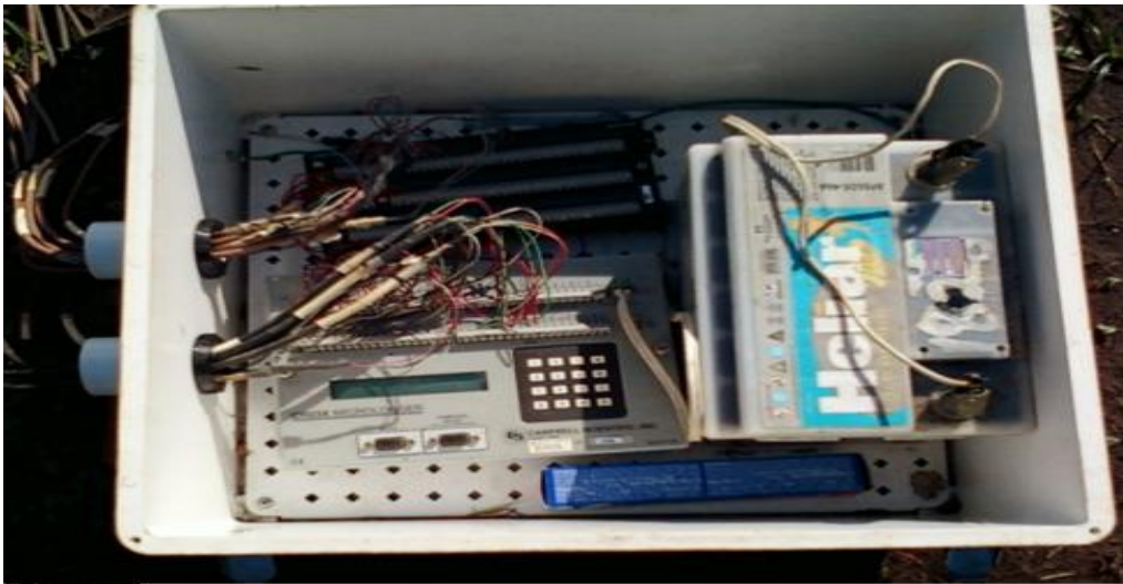
Foto B – Sistema de aquisição de dados microclimáticos. Ponta Grossa - PR, UEPG, 2011.
