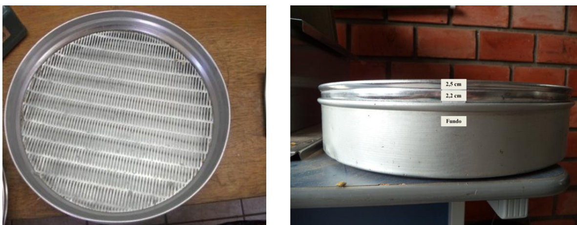
Figura 1 - Vista dos crivos oblongos das peneiras utilizadas para classificação das sementes (esquerda), sequência de espessura dos crivos das peneiras utilizada para classificação das sementes: 2,5 mm x 22,0 mm e 2,2 mm x 22,0 mm de espessura + fundo (direita).
