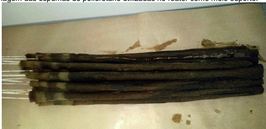
Figura 8. Imagem das espumas de poliuretano utilizadas no reator como meio suporte.
