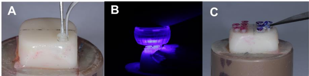
Figura 5. Inserção do cimento resinoso nos tygons (A); fotoativação dos cimentos (B) e remoção dos tygons para armazenamento em estufa (C).
