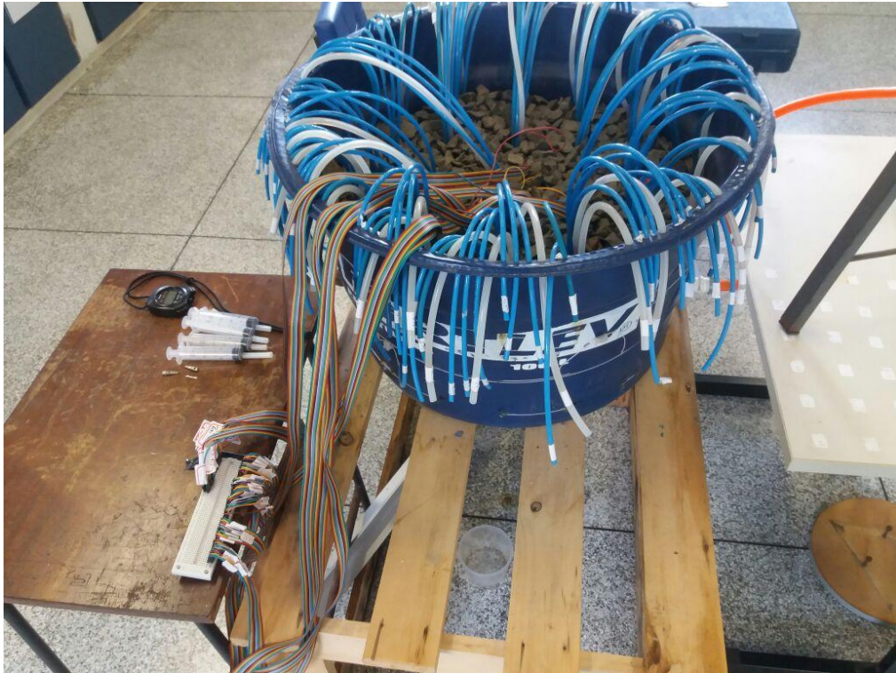
FIGURA 15- TANQUE UTILIZADO PARA OS TESTES COM CAMADA SUPORTE E OS ELETRODOS DE MEDIÇÃO INDIRETA INSTALADOS.
