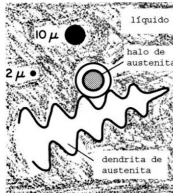
Figura 3.3 – Estágio de crescimento do nódulo de grafita, envolvida por um halo de austenita
