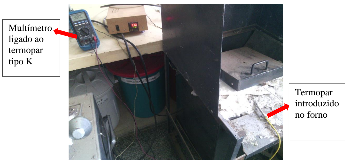
Figura 4.3 – Conjunto termopar tipo k e multímetro, ligados ao forno
