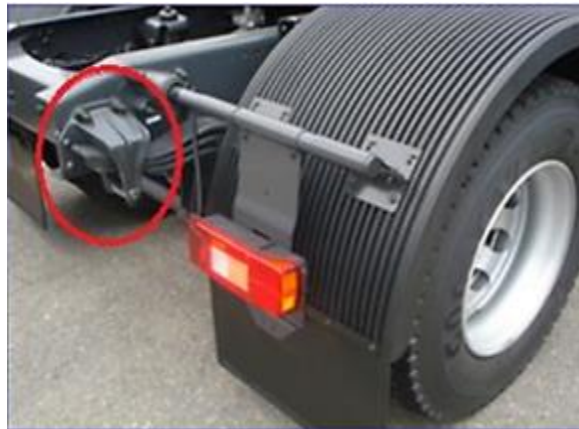
Figura 3.15 – Suporte de feixe de mola fabricado em ADI
