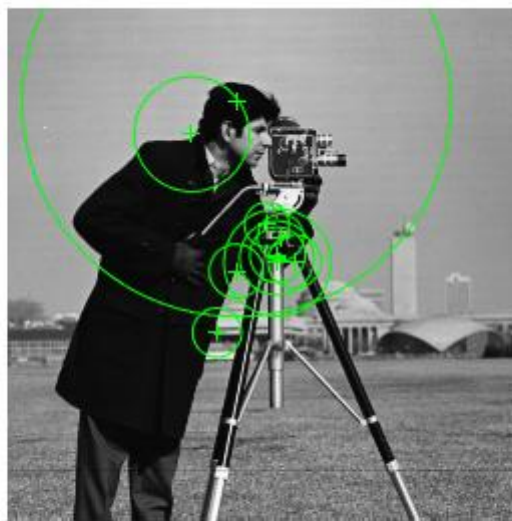
Figura 30- Imagem com pontos-chave calculados pelo algoritmo BRISK.
