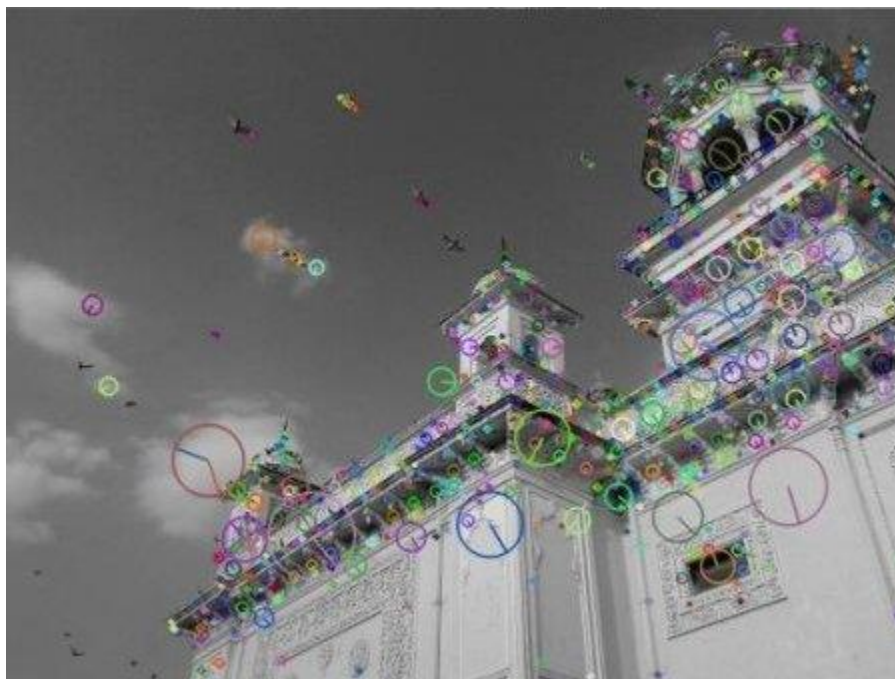
Figura 27- Imagem com pontos-chave e sua orientação usando SIFT
