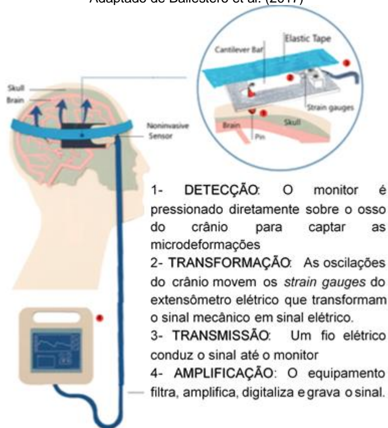
Figura 4 - Desenho esquemático da técnica não invasiva de monitorização da morfologia da PIC. Adaptado de Ballesteró et al. (2017)
