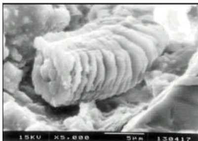
Figura 2.8 - Resultado de MEV apresentando o mineral caulinita em forma de “sanfona”.
