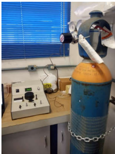
Figura 4.5 - Picnômetro a gás He utilizado neste trabalho para realizar as medidas de densidade de partículas e o cilindro e de gás He.
