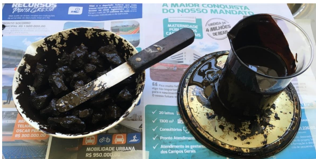
Figura 7 – Realização da mistura de agregado reciclado e emulsão asfáltica
