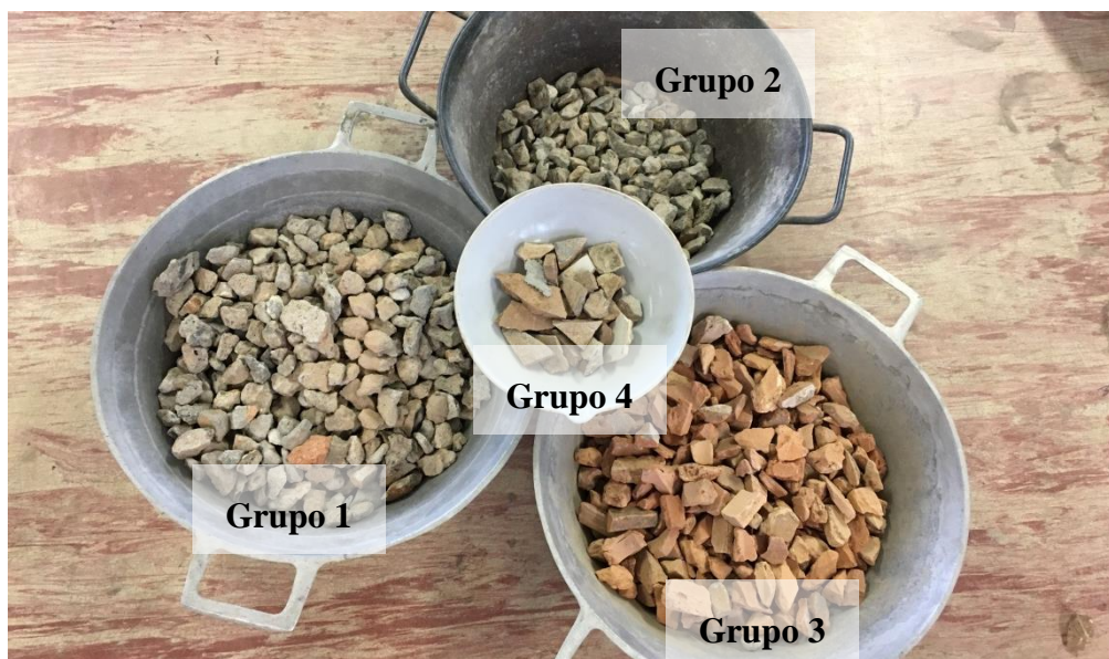
Figura 13 – Frações obtidas na análise visual da composição do agregado reciclado misto
