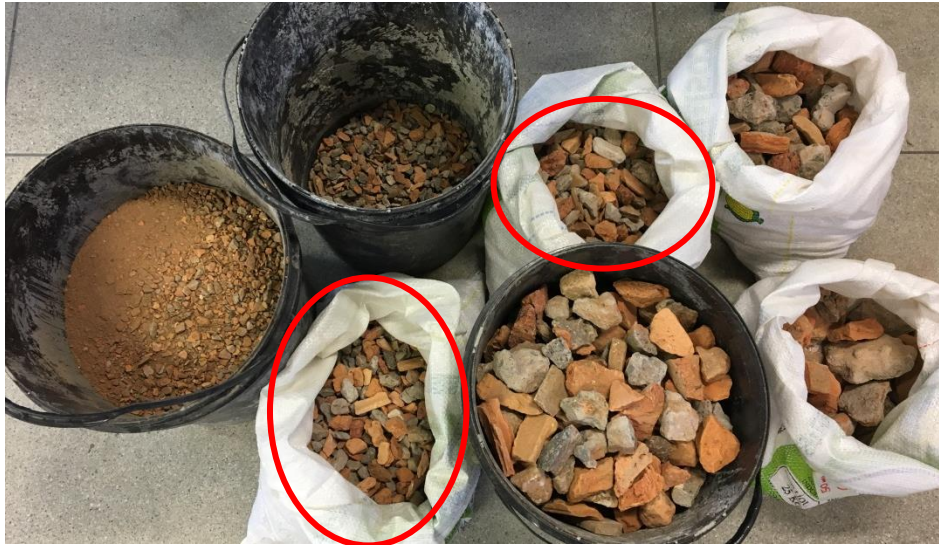
Figura 4 – Frações componentes do agregado reciclado misto (ARM) produzido pela Cooperconcre
