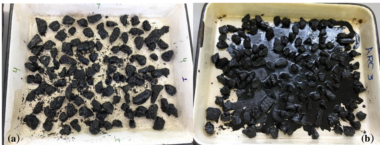
Figura 6 – Agregado reciclado de concreto coberto com emulsão asfáltica
