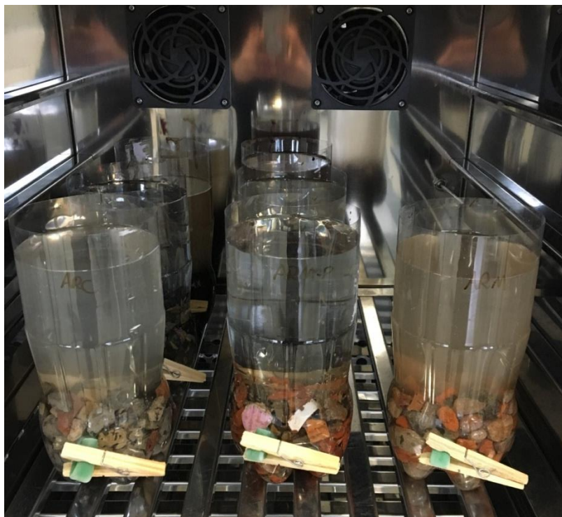
Figura 10 – Recipientes suportes posicionados na incubadora, preenchidos com agregados e água
