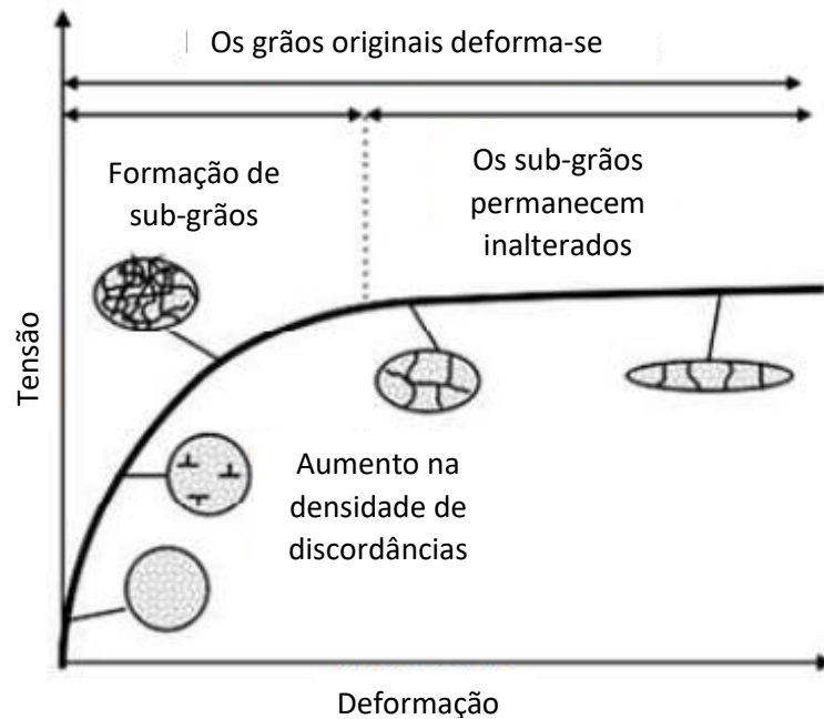
FIGURA. 6 - Curva tensão-deformação do processo de recuperação dinâmica detalhando os aspectos microestruturais
