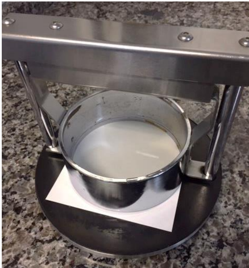
Figura 72 - Configuração do sistema utilizado para teste Cobb. Neste uma amostra de papel cartão com as dimensões de 14 x 14 cm está anexada e existe uma coluna de água (100 ml) em sua superfície.
