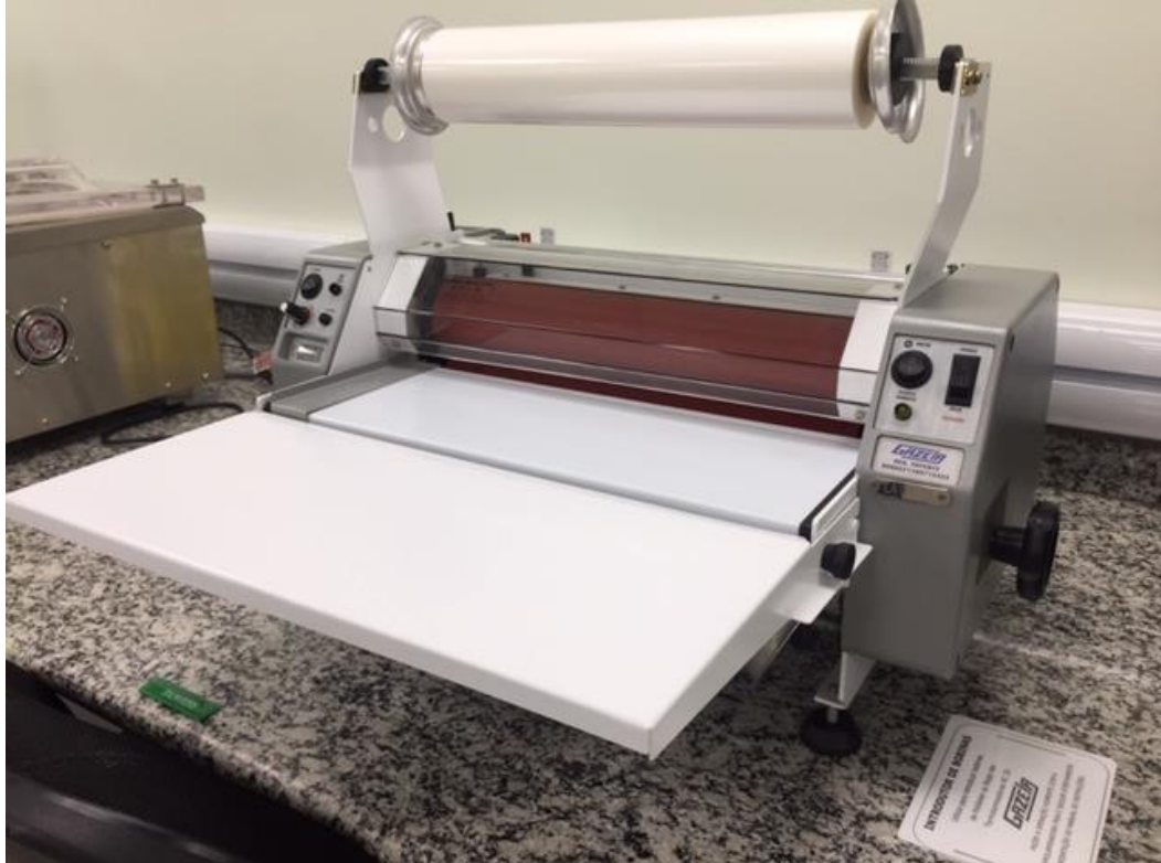
Figura 21 - Termolaminadora Gazela utilizada para o processo de laminação das amostras de cartão com os filmes poliméricos.
