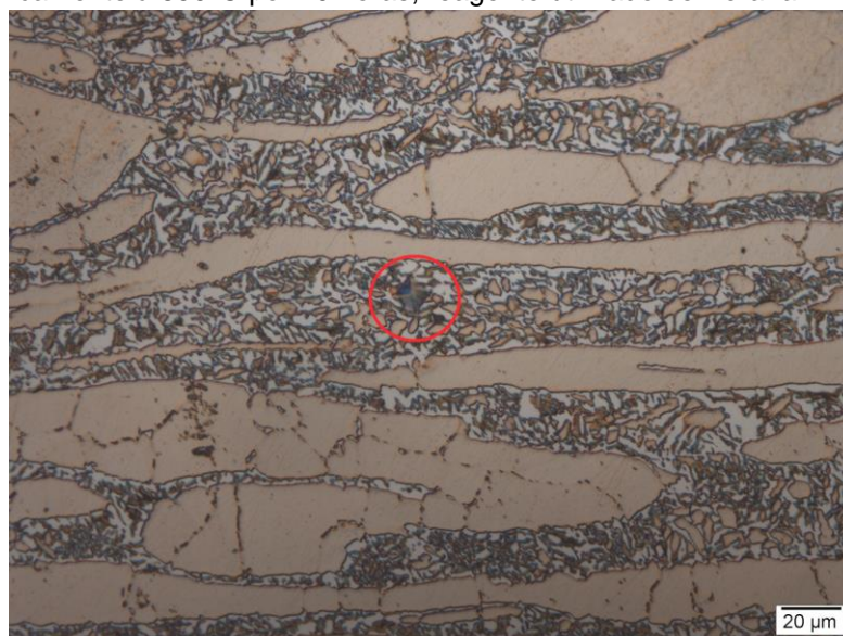
Figura 5.21 – Marca do penetrador do ensaio de microdureza Vickers, de uma amostra tratada termicamente à 850°C por 10 horas, reagente utilizado de Beraha II modificado.
