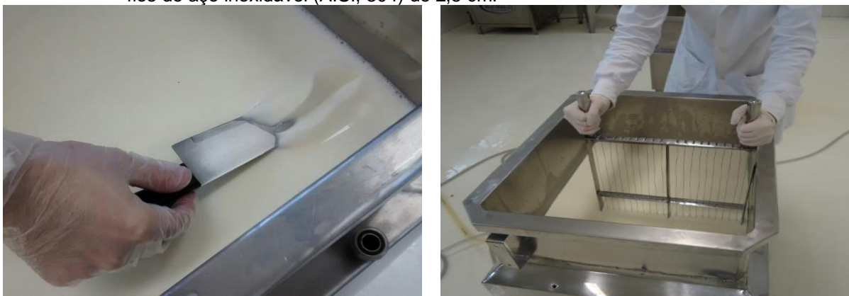
Figura 1.2- Ponto de corte da massa e corte da massa, com auxílio de liras com espaçamento entre os fios de aço inoxidável (AISI, 304) de 2,5 cm.
