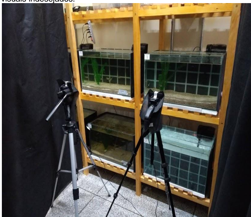
Figura 4 – Set de filmagem onde foram filmados os experimentos, montado com paredes pretas para evitar estímulos visuais indesejados.
