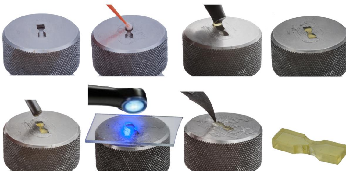
Figura 3. Confeção de corpos de prova de adesivo (CPA), para teste de resistência máxima à tração
