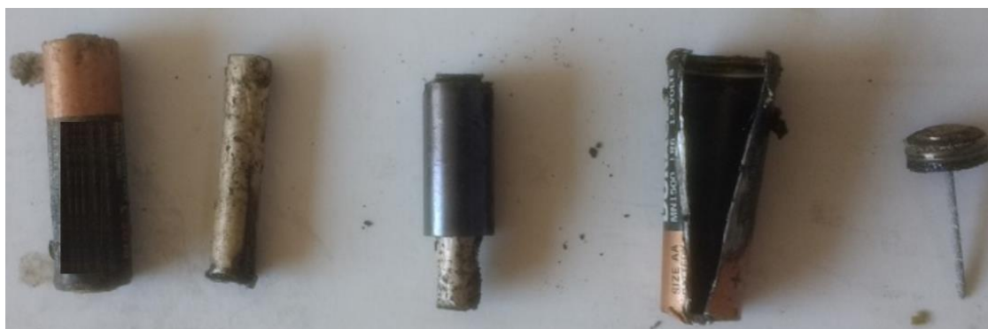
Figura 6 – Componentes da pilha alcalina separados após o processo de desmantelamento
