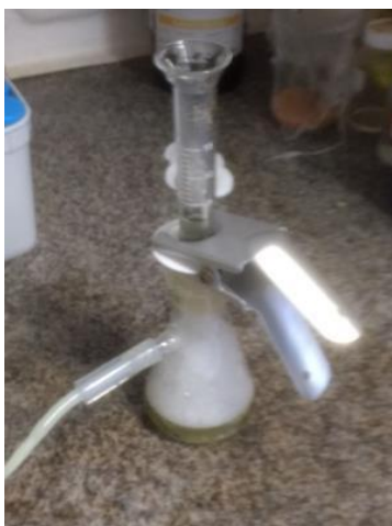
Figura 7 – Sistema utilizado no processo de filtração das soluções lixiviadas
