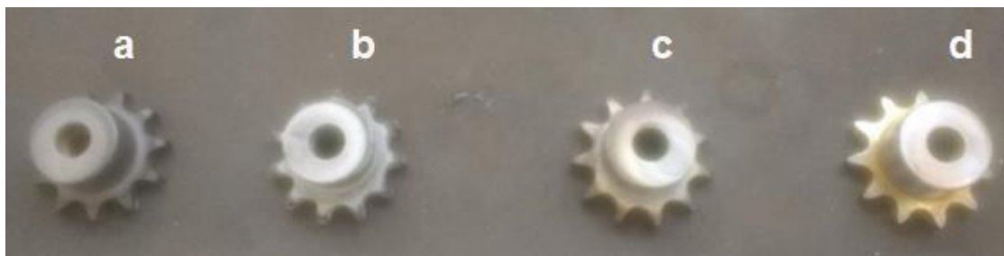
Figura 44 – Peças de geometria variável com os revestimentos obtidos a partir do banho eletrolítico com (a) PEG (b) TIO (c) PEG e TIO e (d) sem revestimento
