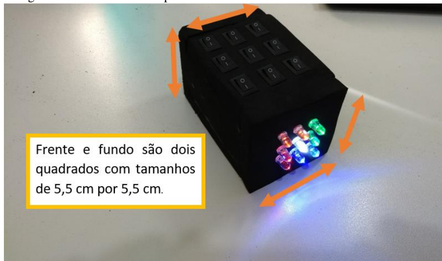
Fotografia 1 – Dimensões das partes da frente e do fundo do iluminador.
