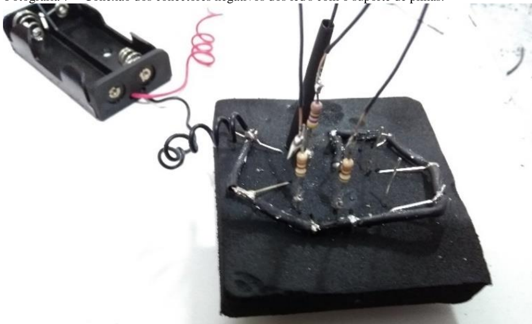
Fotografia 7 – Conexão dos conectores negativos dos led's com o suporte de pilhas.
