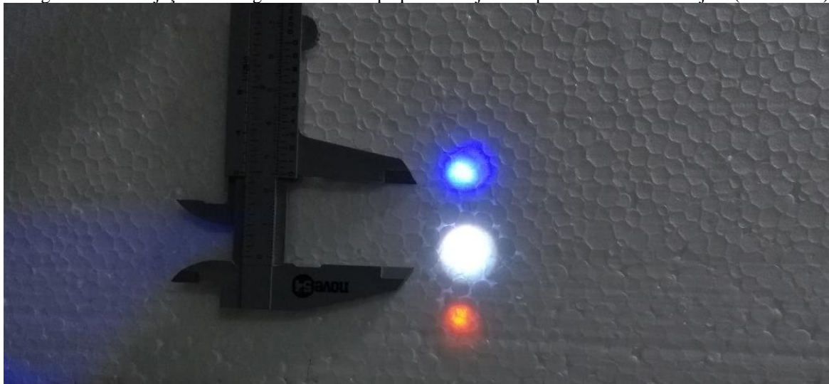
Fotografia 13 – Projeção da fotografia 12 com o paquímetro ajustado para o tamanho do objeto (iluminador).
