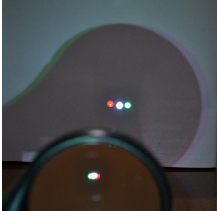
Fotografia 16 – Inversão horizontal da imagem formada através de uma lente convergente.
