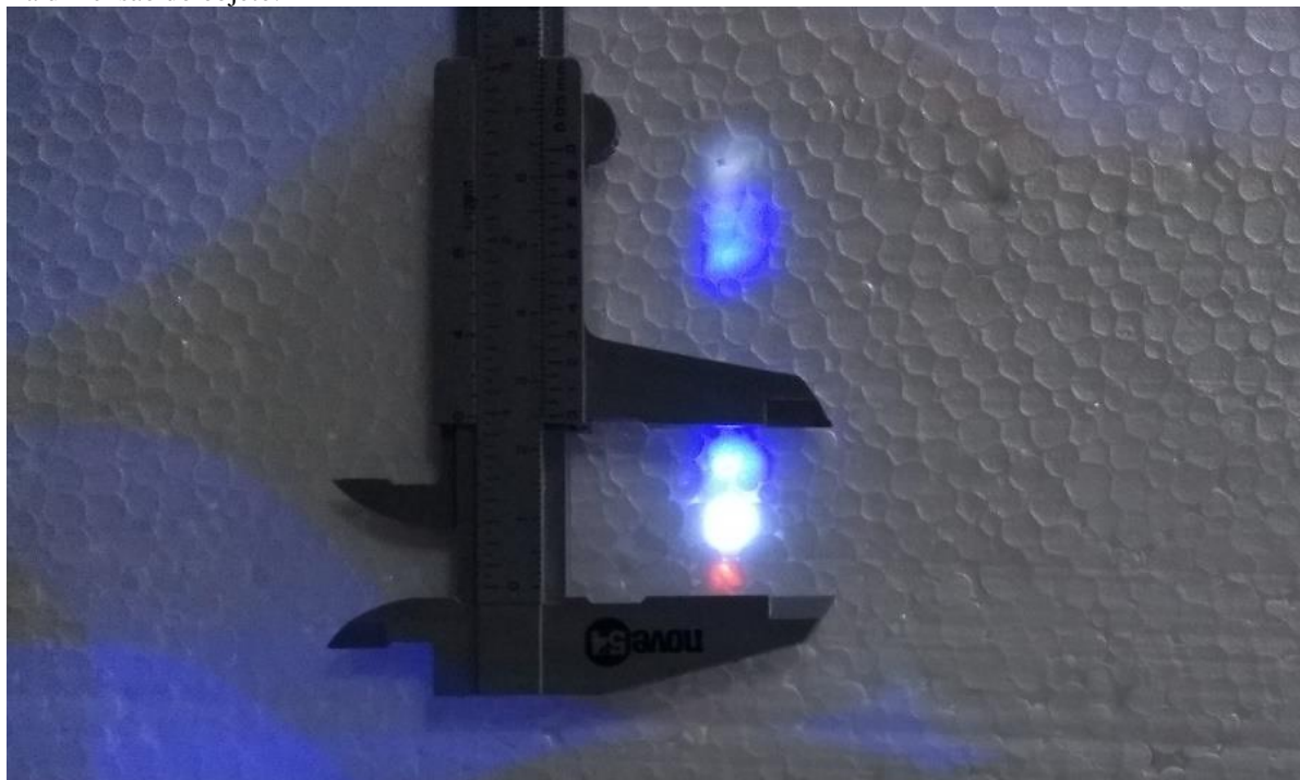
Fotografia 11 – Comparação do tamanho da imagem formada com o paquímetro que foi previamente ajustado na dimensão do objeto.
