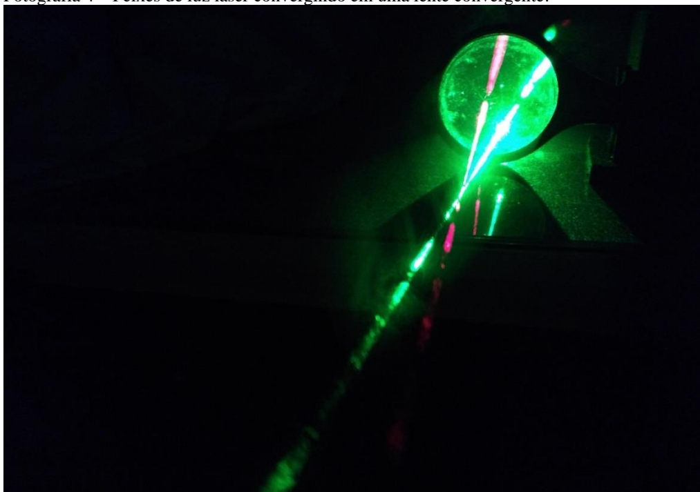
Feixes de luz laser convergindo em uma lente convergente vista da direção contrária à de propagação do feixe de luz.
