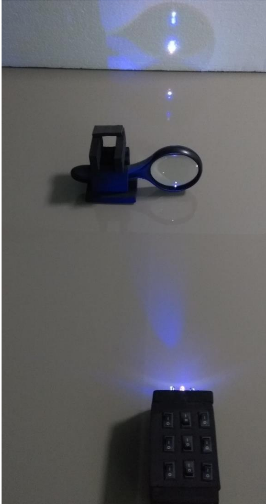
Fotografia 21 – Iluminador (objeto) posicionado à distância equivalente ao dobro da distância do foco da lente.
