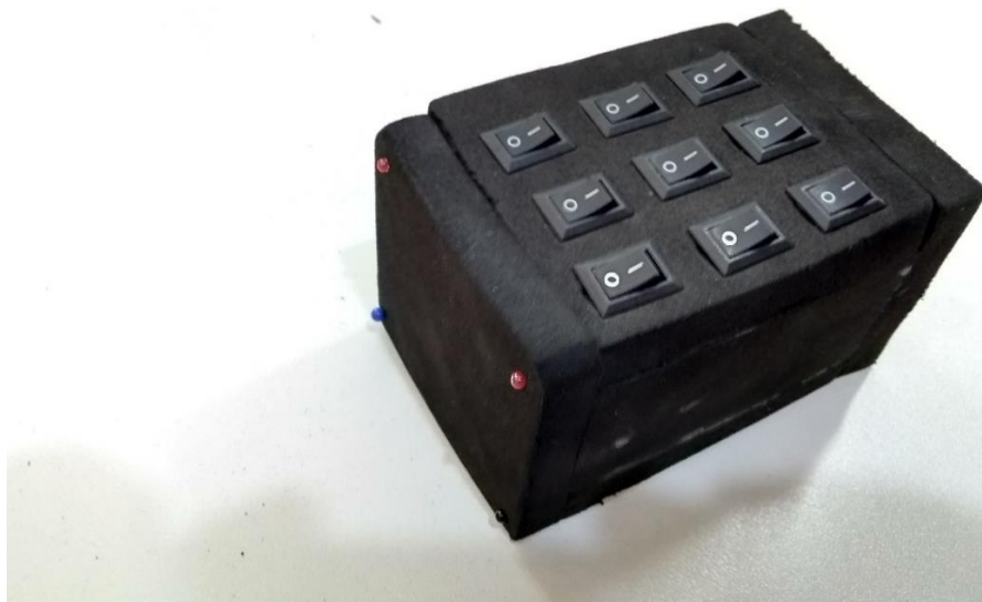
Fotografia 12 – Iluminador finalizado com sua tampa traseira fixada por alfinetes.
