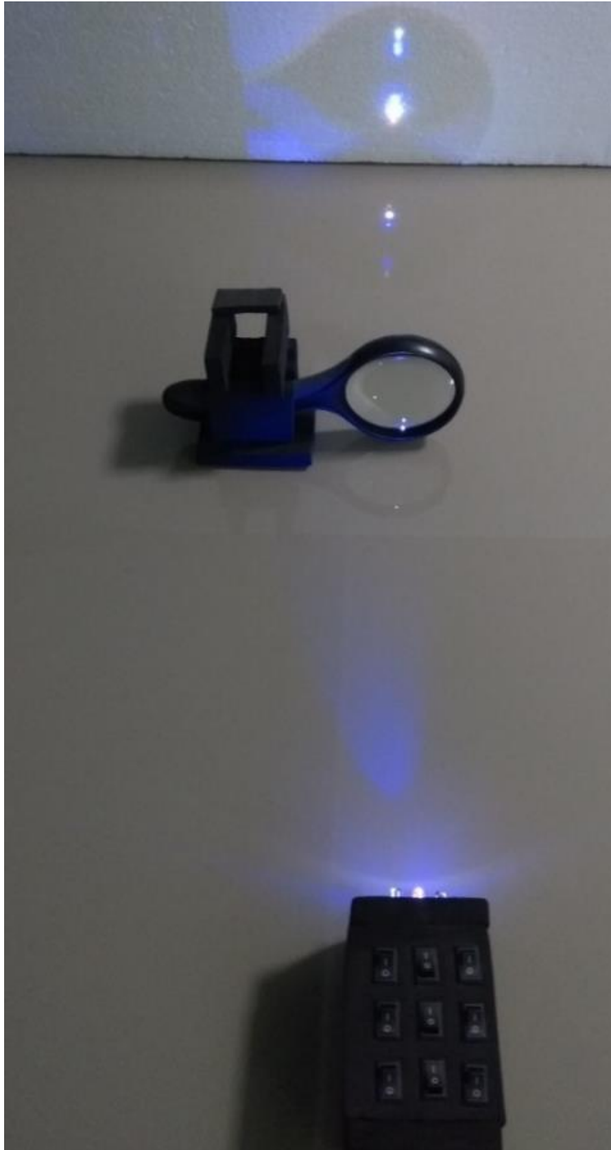
Fotografia 10 – Iluminador (objeto) posicionado à distância equivalente ao dobro da distância do foco da lente.
