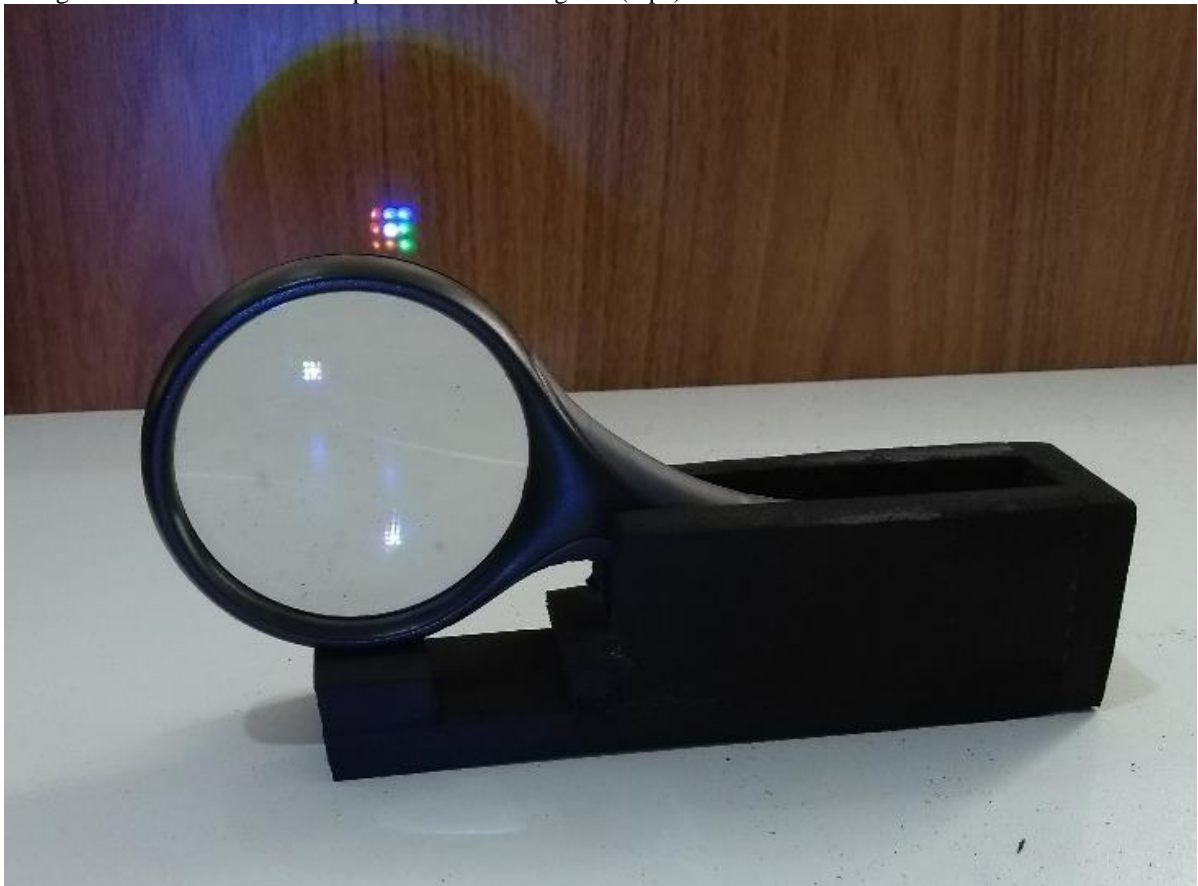
Fotografia 13 – Base de E.V.A. para a lente convergente (lupa).
