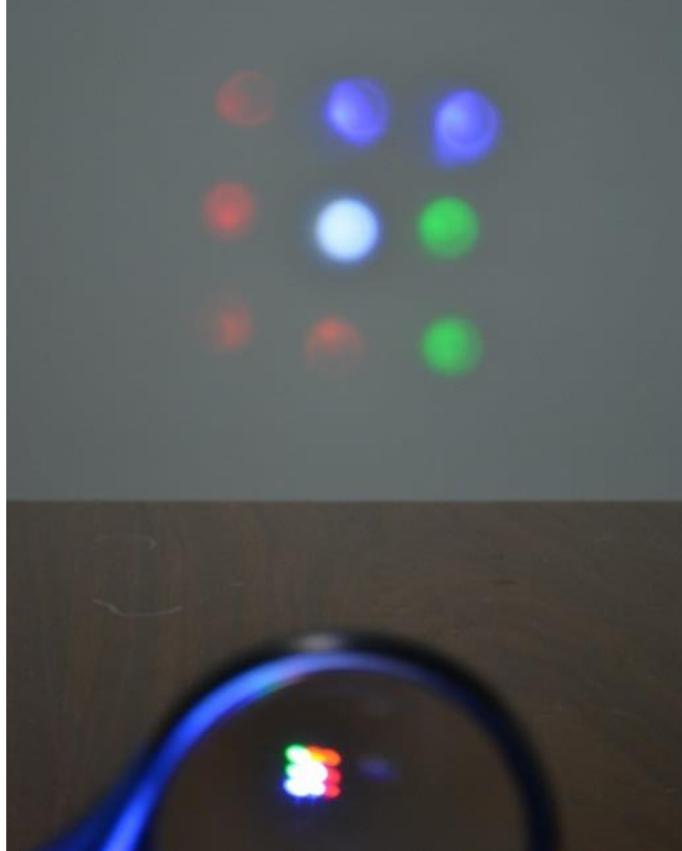
Fotografia 15 – Projeção da imagem numa parede a dez metros de distância da lente convergente.
