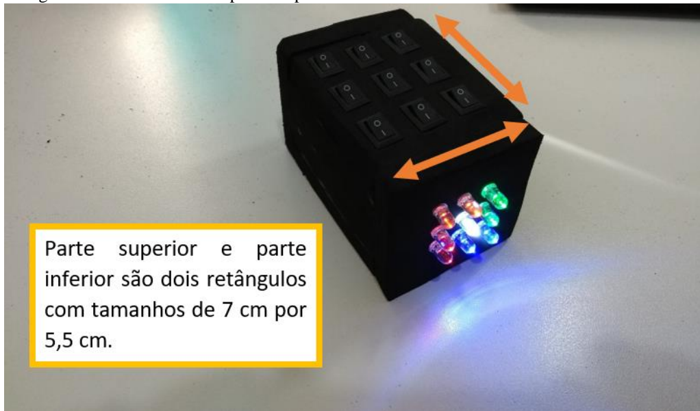
Fotografia 3 – Dimensões das partes superior e inferior do iluminador.
