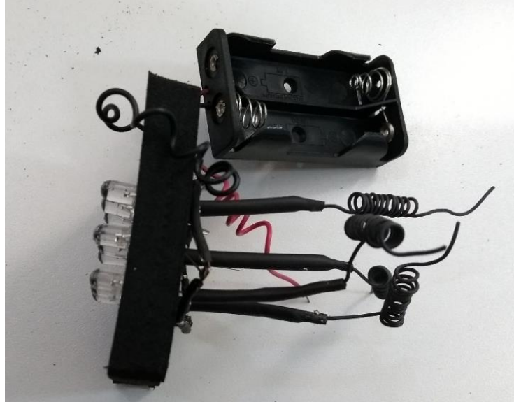
Fotografia 8 – Solda individual dos conectores positivos de cada led.
