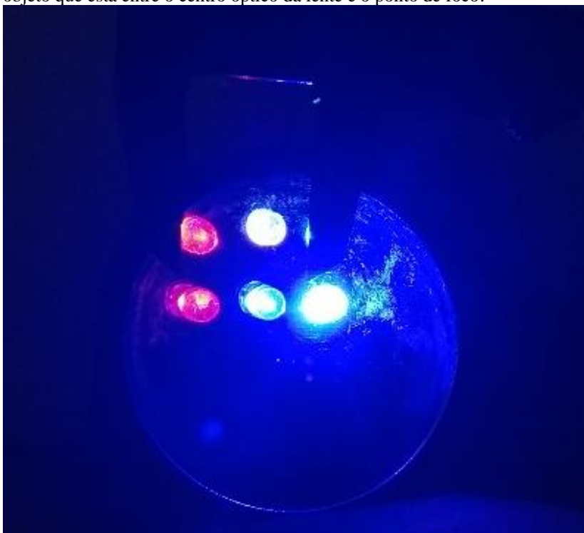
Fotografia 23 – Imagem virtual visualizada atrás da lente convergente de um objeto que está entre o centro óptico da lente e o ponto de foco.
