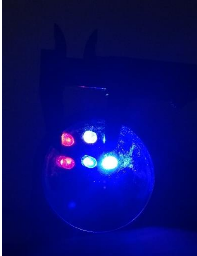
Fotografia 34 – Imagem virtual visualizada atrás da lente convergente de um objeto que está entre o centro óptico da lente e o ponto de foco.
