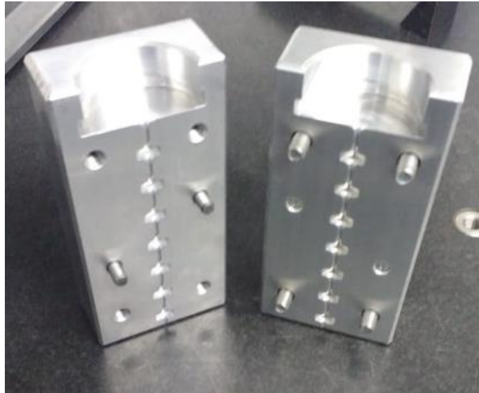
Figura 22 – Matriz hiperbólica utilizada no DMFE
