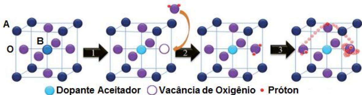
Figura 23- Esquema ilustrando as etapas desde a dopagem ao movimento do próton na estrutura
