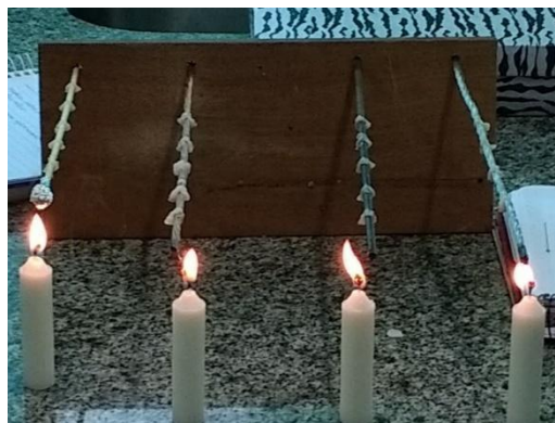
Figura 3: Montagem experimento de como ficam dispostas as hastes de diferentes materiais condução de calor.
