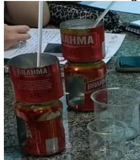
Figura 14: A imagem a esquerda mostra como foi feita a lamparina e os recipientes usados no experimento, a figura do meio mostra o experimento montado com termômetro analógico e a figura a direita mostra o experimento montado com um termômetro digital.
