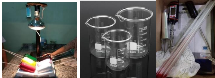
Figura 20: Aparato e materiais para o experimento que mostra a absorção da Radiação térmica em função da cor de um objeto.
