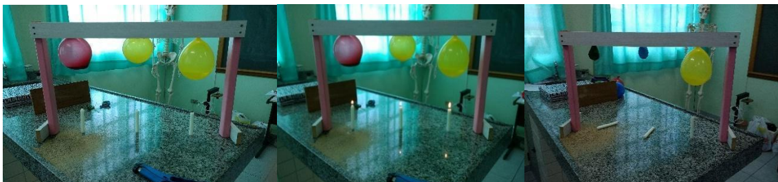
Figura 13: Experimento exemplificando calor específico dentro dos balões havia substâncias diferentes. As velas aquecem os balões, aquele cuja substância tem maior calor específico estourará mais tarde
