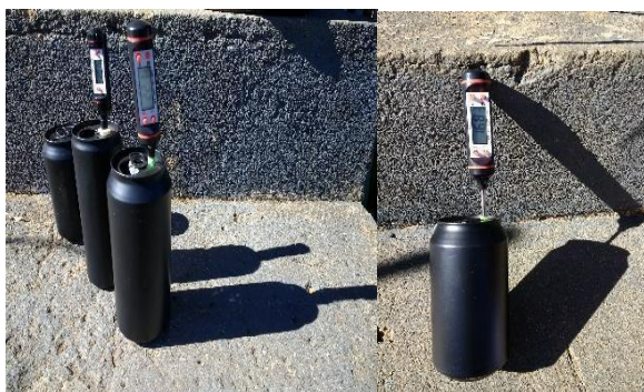
Figura 10: Absorvendo radiação solar.
