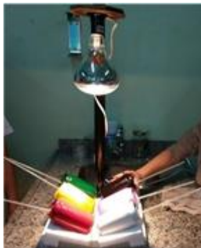
Figura 21: Aparato e materiais para o experimento que mostra a absorção da Radiação térmica em função da cor de um objeto.
