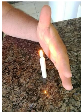
Figura 17: A imagem mostra como se deve posicionar a mão próximo a vela no experimento Transferência de calor por Irradiação.
