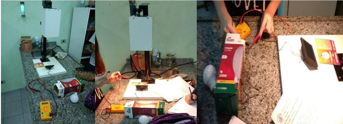
Figura 23: A imagem à direita mostra os materiais utilizados no experimento com o suporte, multímetro, painel solar e lâmpadas, a imagem do meio a lâmpada ligada com o painel solar abaixo e a imagem à direita destaca o painel solar e o multímetro.
