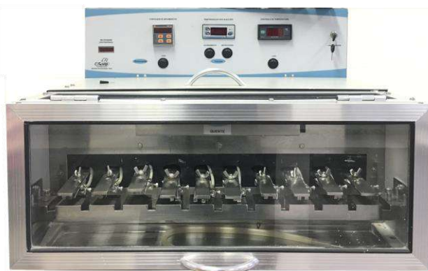
Figura 6. Aparelho de escovação simulada (EIQuip), utilizado no trabalho.
