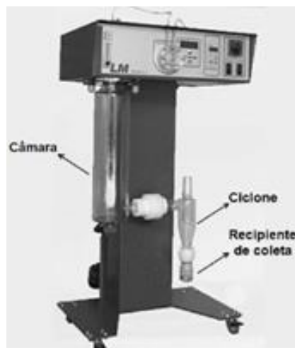
Figura 12 : Spray dryer (MSD 0,5 Labmaq, Brasil) e os principais componentes.
