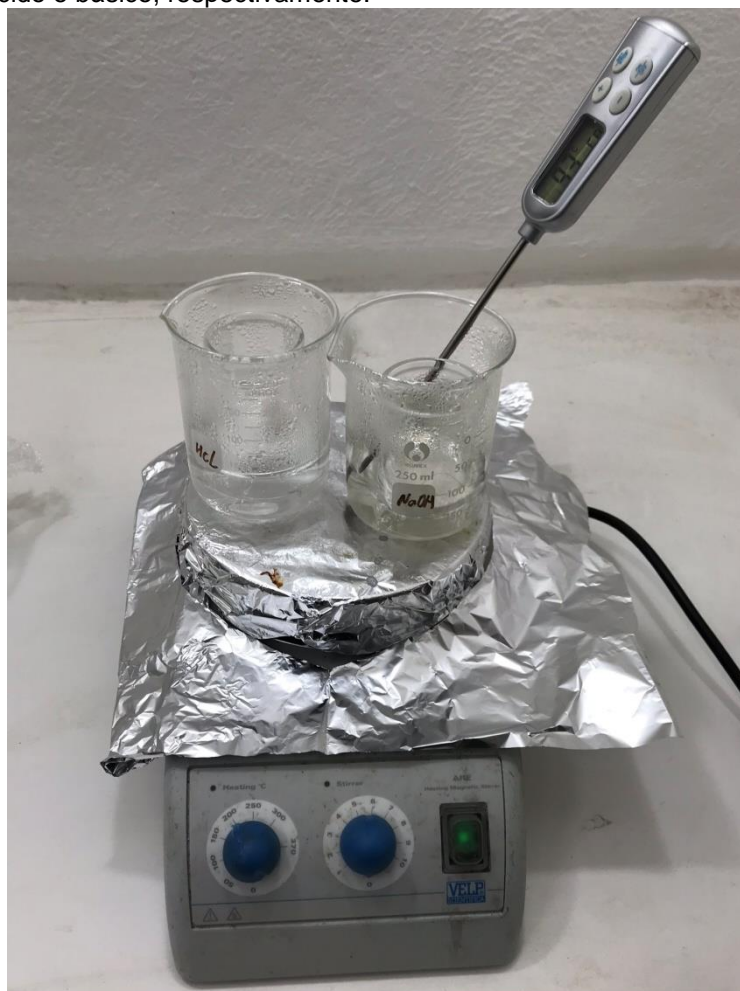
Figura 2.28 – Amostra de vidro e amostra sinterizada da composição CP1 em teste de durabilidade química em meio ácido e básico, respectivamente.
