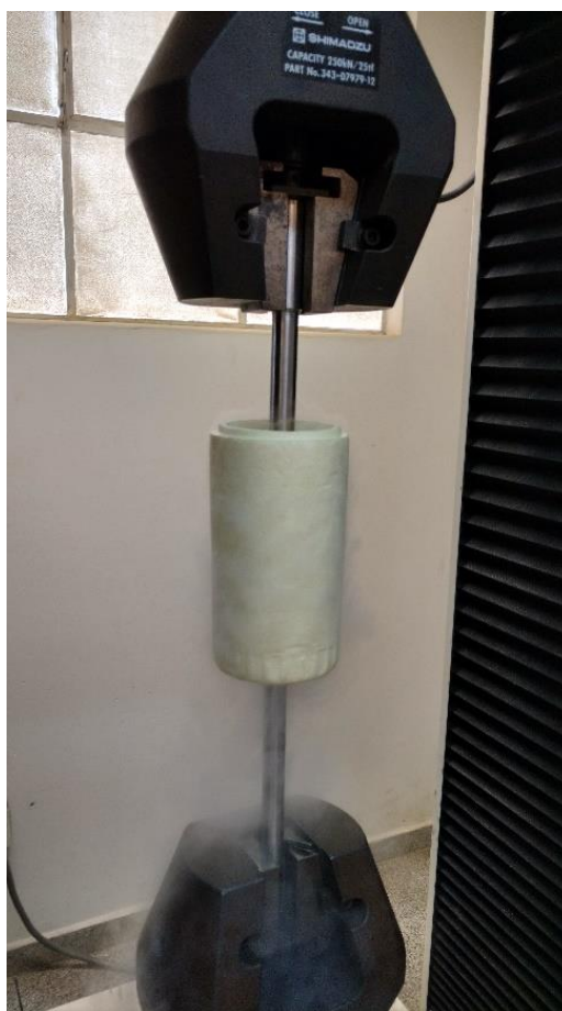
Figura 39: Aparato utilizado para a realização de ensaios de tração em temperatura criogênica.
