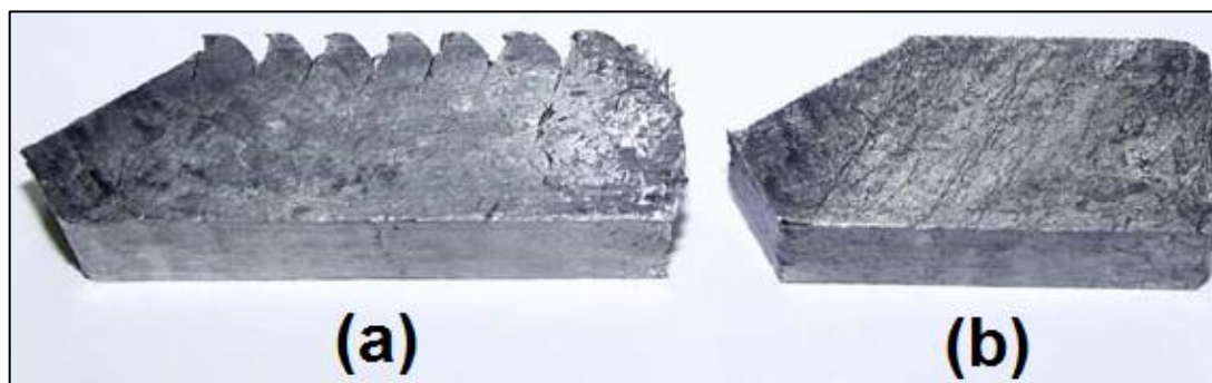
Figura 8: Liga de magnésio compactada pelo processo de ECA sem contrapressão (a) e com contrapressão (b). Em (a) é possível observar o comportamento de fratura característico de materiais processados por ECA sem contrapressão
