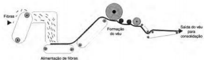
Fig. 3 - Processo de fabricação Via Carda (cardagem) – (Carded) Consolidação por agulhagem.
