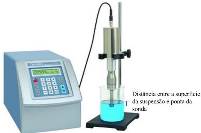
Figura 2.1 – Posicionamento do probe durante tratamento por US
