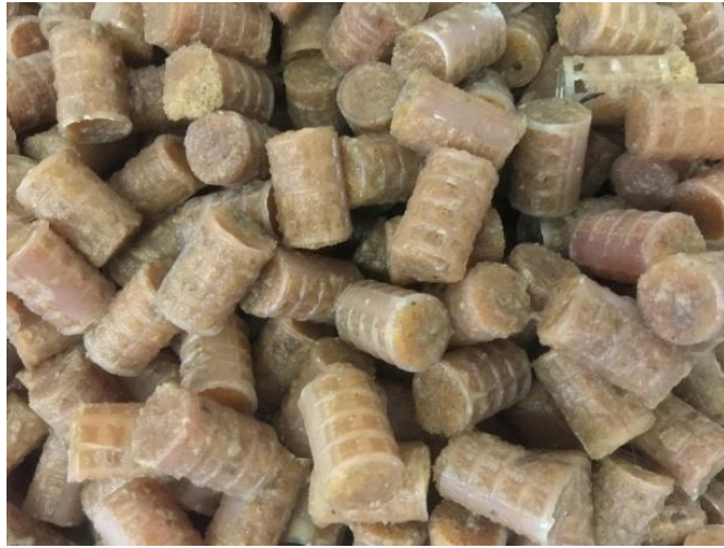
Figura 2.7 Estrutura do meio suporte: miniBiobobs® inoculados
