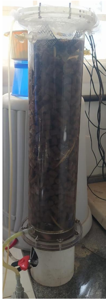
Figura 2.5 Reator de leito empacotado com recirculação e aeração intermitente: estrutura real.
