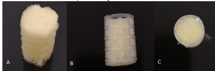
Figura 2.6 Estrutura do mini BioBob ® . A) Espuma interna, sem a proteção de PEAD; B) Vista lateral do mini BioBob ® . C) Vista superior do miniBioBob ®
