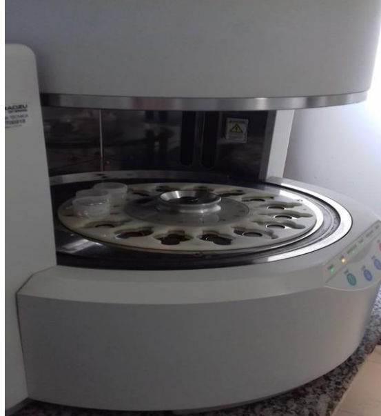
Figura 4. 10 - Equipamento EDX – 720, da marca Shimadzu, local onde ficam localizados os porta amostras.
