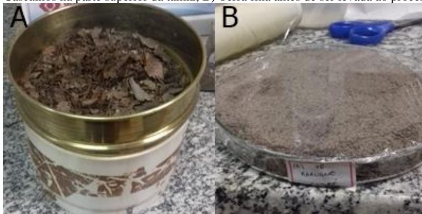
Figura 4. 4 - A) Cascalhos na parte superior da tamiz; B) Terra fina antes de ser levada ao processo de secagem.
