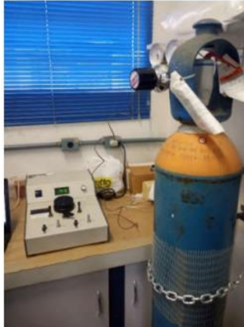
Figura 4. 5 - Multipiquinômetro MVP – D160 – E com cilindro de gás hélio vinculado.
