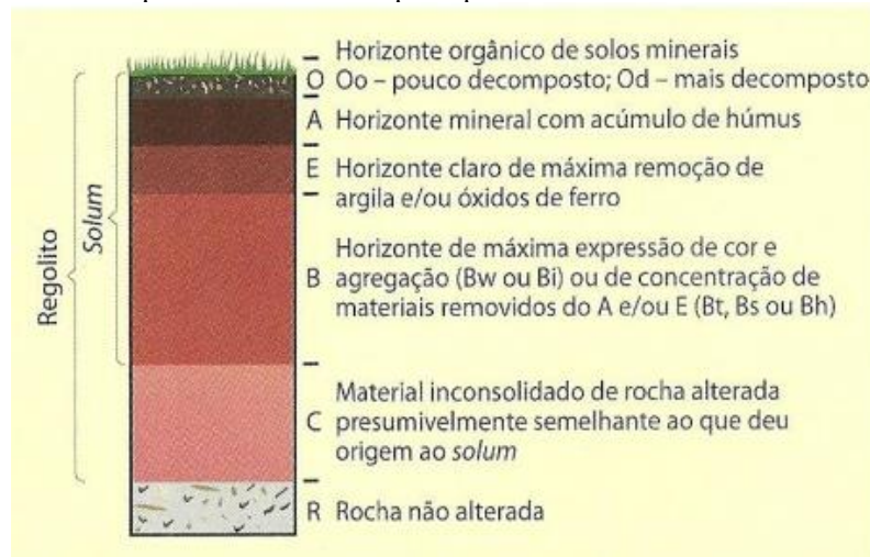
Figura 2. 4 - Esquema de um perfil de solo com os principais horizontes e sub-horizontes.
