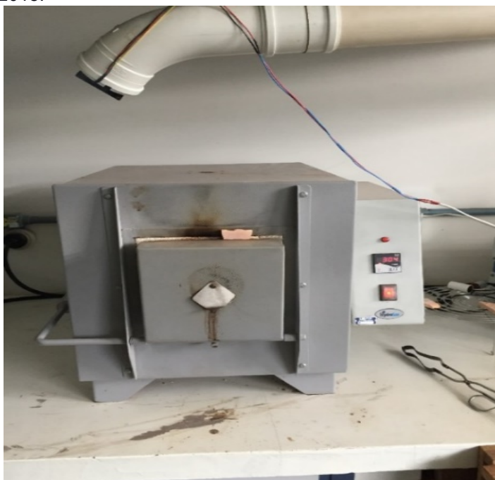
Figura 13 – Forno mufla Zezimaq® para o processo de carbonização do carvão de jerivá ( Syagrus romanzoffiana ), laboratório de química, Universidade Estadual de Ponta Grossa, Ponta Grossa, 2018.
