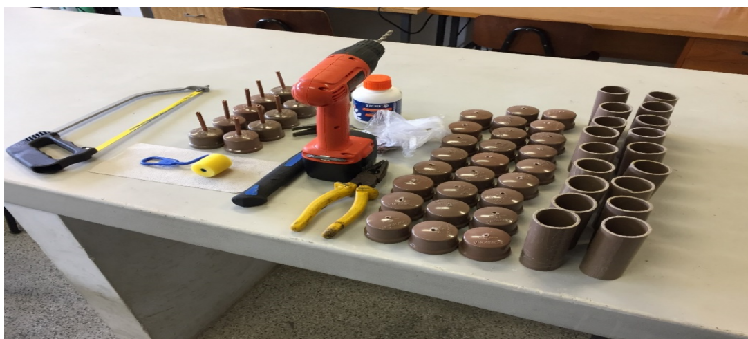
Figura 16 – Processo de construção dos filtros para remoção do \text{H}_2\text{S} em gás produzido por biodigestor alimentado com resíduo de bovinocultura, laboratório de química, Universidade Estadual de Ponta Grossa, Ponta Grossa, 2018.
