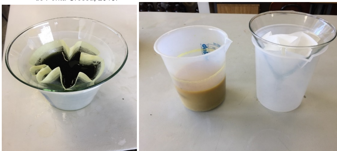
Figura 14 – Processo de filtragem dos materiais após processo de adsorção com cloreto de ferro, realizada com filtros de filtragem rápida em laboratório de química da Universidade Estadual de Ponta Grossa, 2018.
