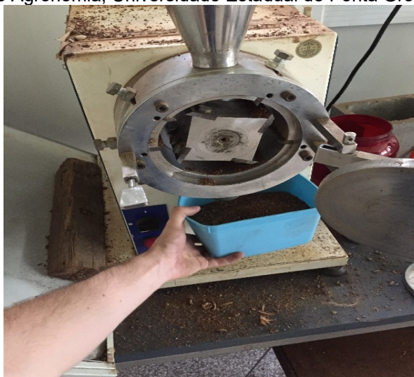
Figura 12 - Moagem da casca do fruto do jerivá ( Syagrus romanzoffiana ), em aparelho de moagem, Laboratório de Agronomia, Universidade Estadual de Ponta Grossa, Ponta Grossa, 2018.
