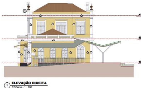
Figura 35: Elevação Lateral direita, telhado quatro águas (edifício) e cobertura tipo borboleta (gare).
