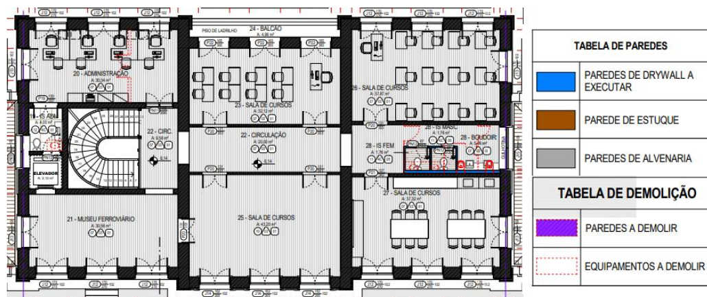
Figura 65: Ampliação Planta Superior.
