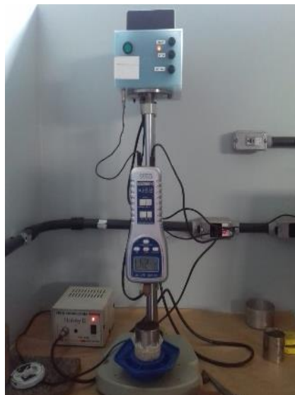
Figura 8: Imagem demonstrando o penetrômetro eletrônico de bancada utilizado na determinação da Resistência do Solo.
