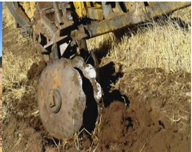
Figura 4: Imagem demonstrando o preparo inicial da área experimental com subsolador e grade de disco acoplada.
