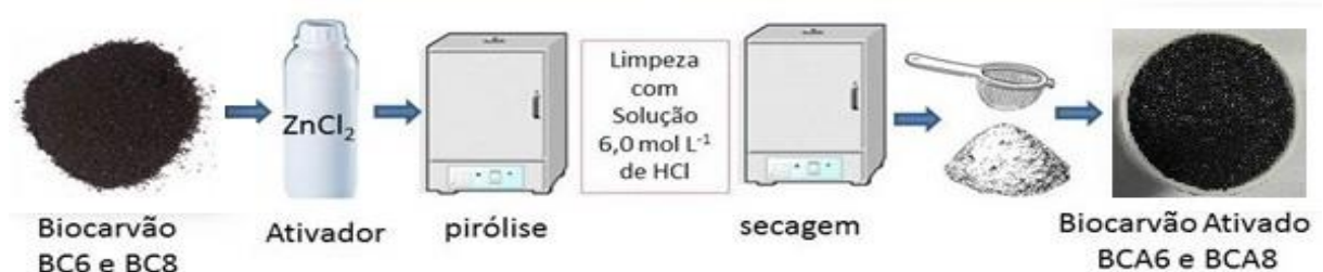
Figura 11: Ativação do biocarvão obtido pela pirólise da biomassa da casca de pinhão
