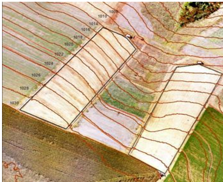
Figura 3 - Imagem da encosta com curvas de nível distanciadas em 2 m, utilizadas para o posicionamento das unidades experimentais. Ao centro, entre as unidades experimentais, encontra-se a linha de drenagem principal
