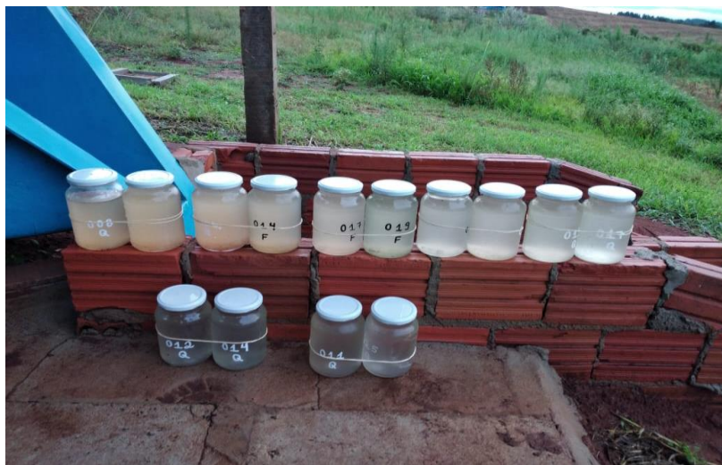
Figura 6 - Coleta do escoamento superficial para quantificar a concentração de sedimentos em suspensão.
