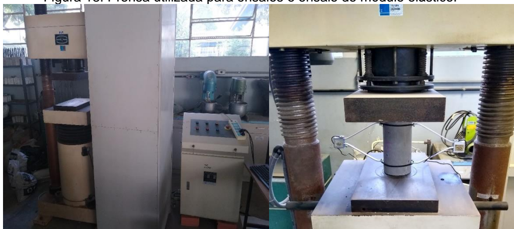
Figura 18: Prensa utilizada para ensaios e ensaio de módulo elástico.
