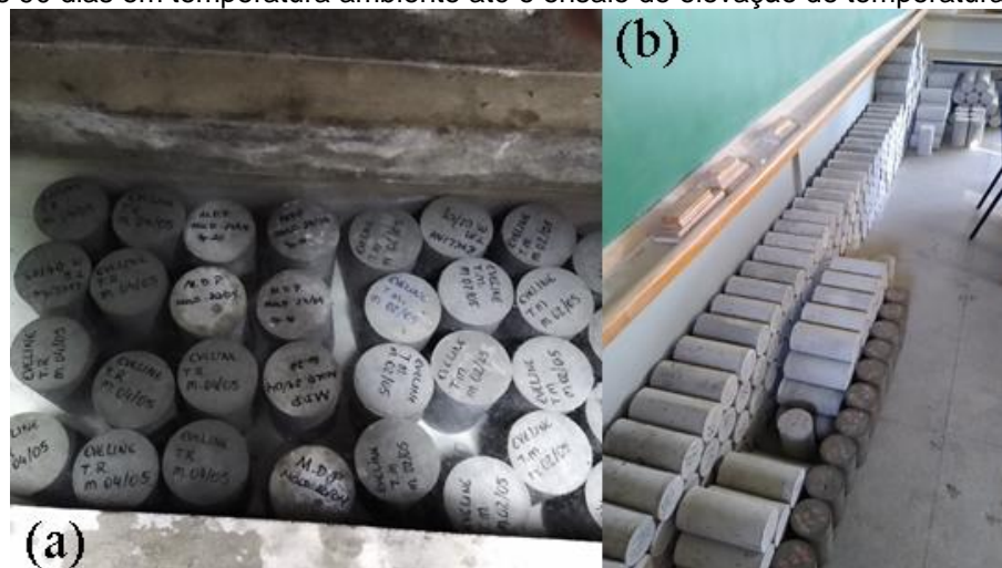
Figura 14: Corpos de prova executados para o ensaio: (a) cura totalmente imersa por 28 dias; (b) mantidos 90 dias em temperatura ambiente até o ensaio de elevação de temperatura
