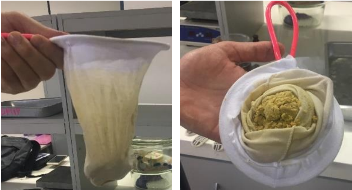
Figura 15- Filtro de pano para separação do material modificado atuando como um filtro prensa na escala industrial.
