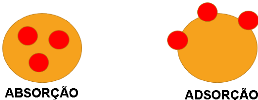
Figura 10- Imagem ilustrativa exemplificando sobre a diferença de fenômenos de transferência de massa entre Absorção e Adsorção
