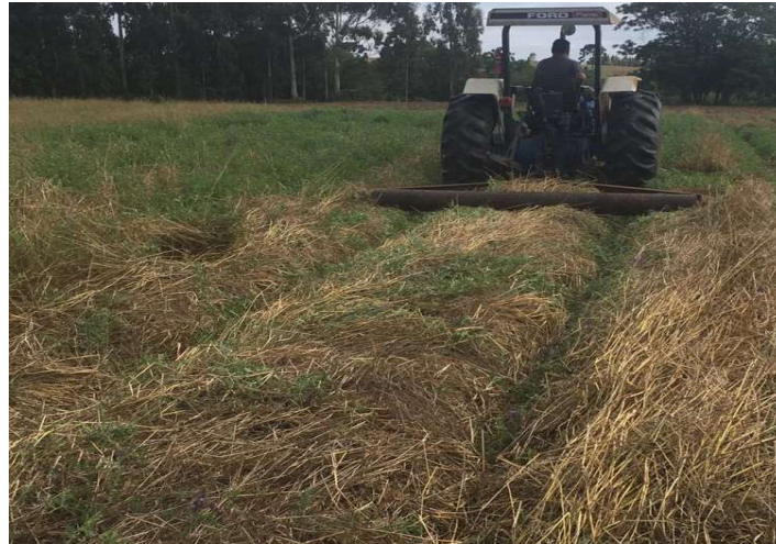
FOTOGRAFIA 1 – Trator acoplado com rolo para manejo da adubação verde de inverno
