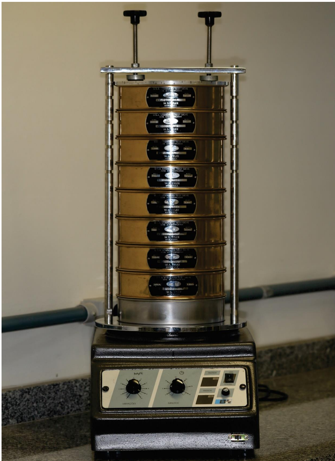
Figura 17: Partículas sendo peneiradas em tamises da maior para a menor, com o auxílio de um vibrador
