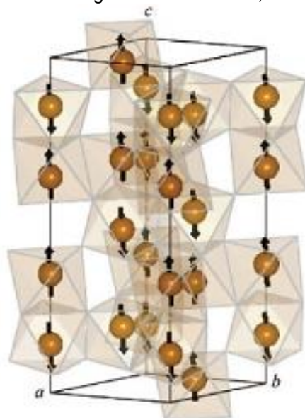
Figura 7. Arranjo esquemático da rede magnética da hematita, abaixo da Transição de Morin ( T_M ).
