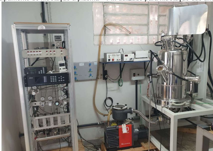
Figura 22 – Equipamento de nitretação a plasma – PIII utilizado para nitretação das amostras.
