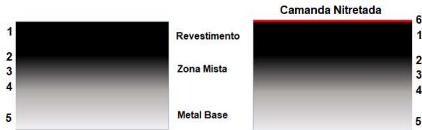
Figura 23 – Representação esquemática de pontos para análise na microscopia ótica, divisão em regiões de interesse ao estudo.
