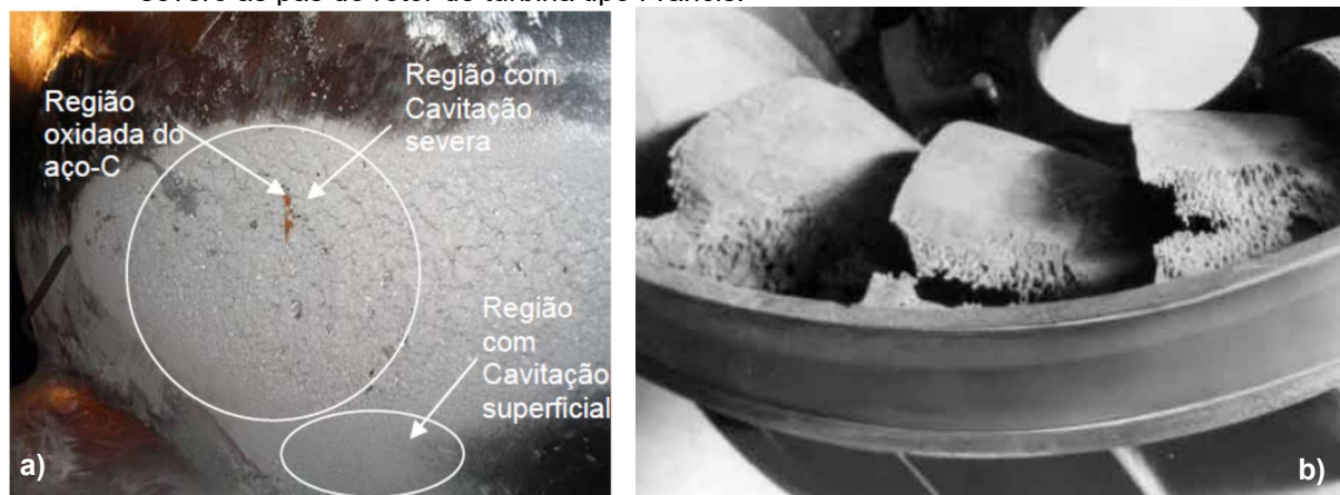
Figura 1 – a) Região cavitada em uma turbina Francis da Usina de Foz do Areia; b) Região com dano severo as pás do rotor de turbina tipo Francis.
