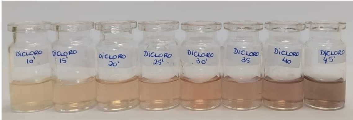
FIGURA 16- Suspensões de AgNPs de diclorometano expostas à luz artificial, nos tempos de 10, 15, 20, 25, 30, 35, 40 e 45 minutos.
