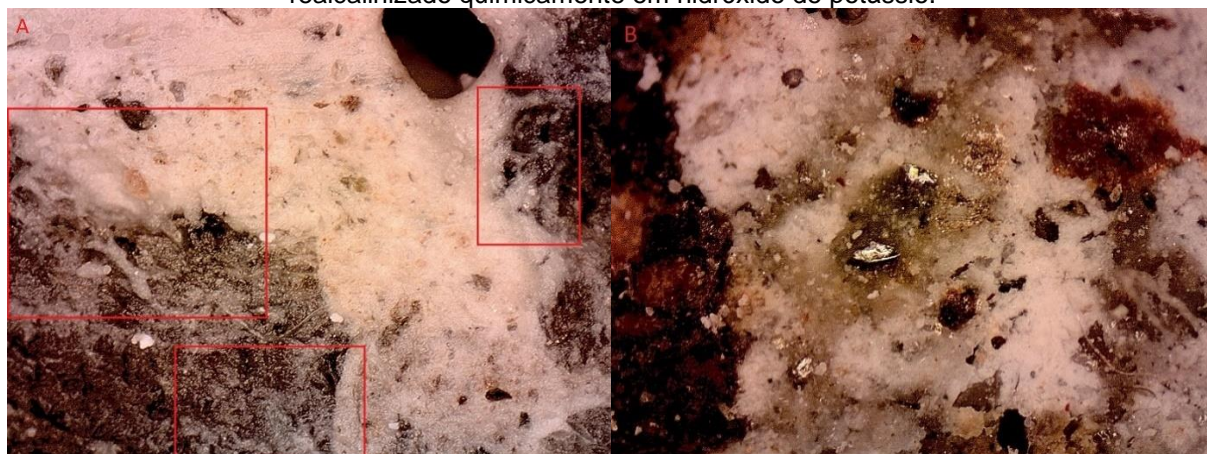
Figura 85 – Imagem de microscopia ótica da zona de transição matriz/agregado do concreto D realcalinizado quimicamente em hidróxido de potássio.
