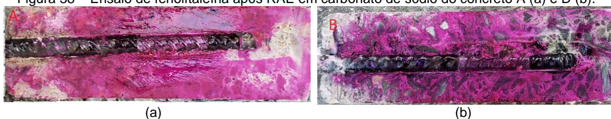
Figura 38 – Ensaio de fenolftaleína após RAE em carbonato de sódio do concreto A (a) e D (b).
