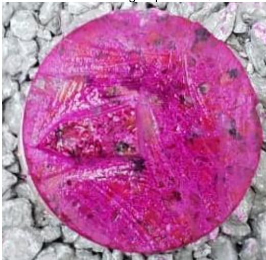
Figura 77 – Ensaio de fenolftaleína logo após RAQ em hidróxido de potássio.
