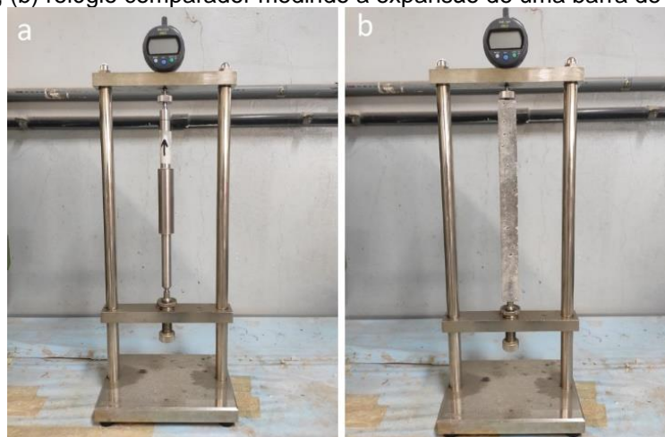
Figura 24 – Relógio comparador utilizado para aferir expansões, (a) relógio comparador com barra de calibração, (b) relógio comparador medindo a expansão de uma barra de argamassa.
