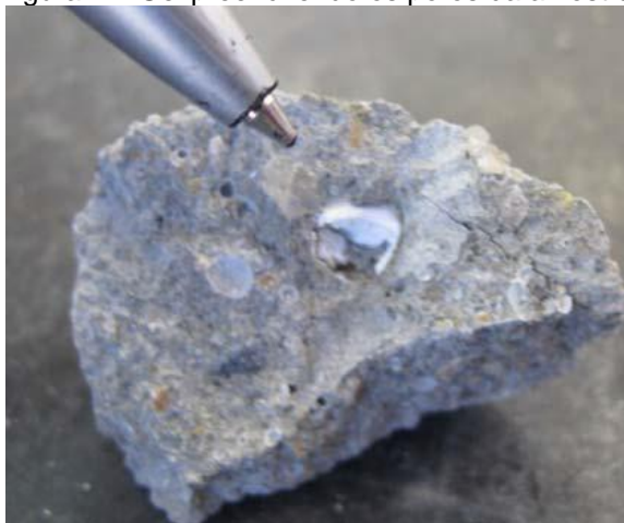
Figura 1 – Gel preenchendo os poros da amostra.
