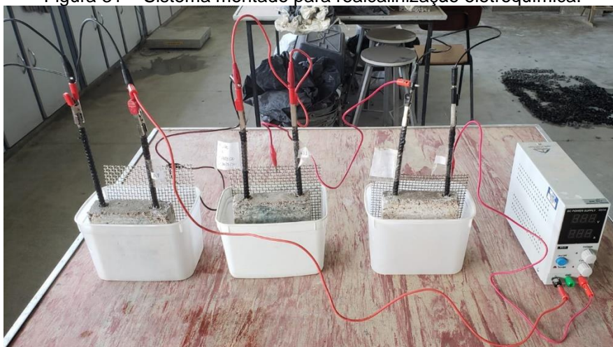
Figura 31 – Sistema montado para realcalinização eletroquímica.
