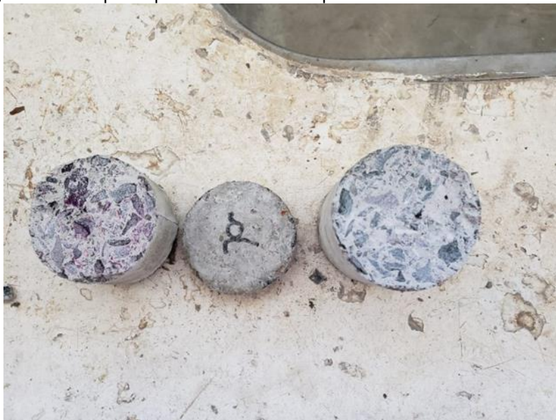
Figura 27 – Corpo de prova carbonatado após dezesseis dias na autoclave.
