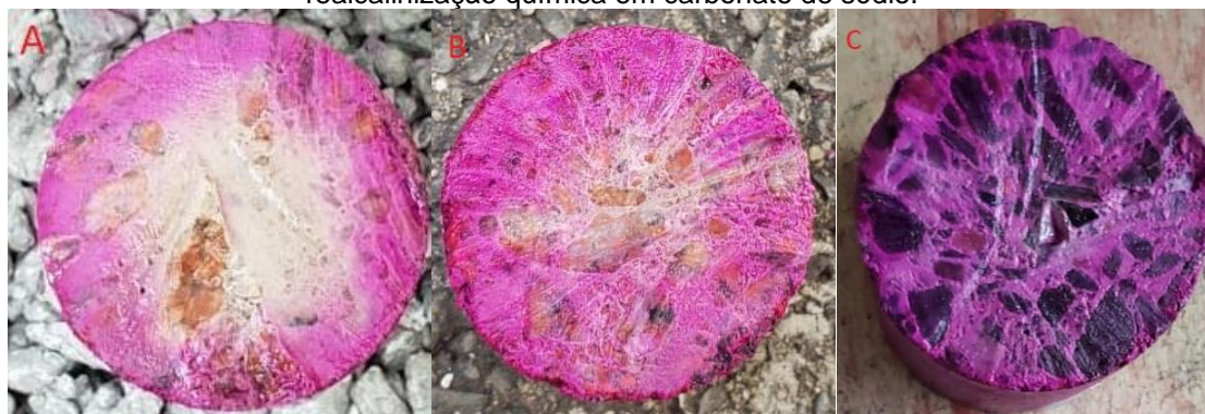
Figura 50 – Ensaio de fenolftaleína 25 (a), 41 (b) e 54 dias (c) após o início do tratamento de realcalinização química em carbonato de sódio.
