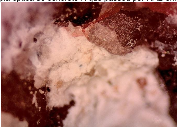
Figura 70 – Microscopia óptica do concreto A que passou por RAE em hidróxido de potássio.
