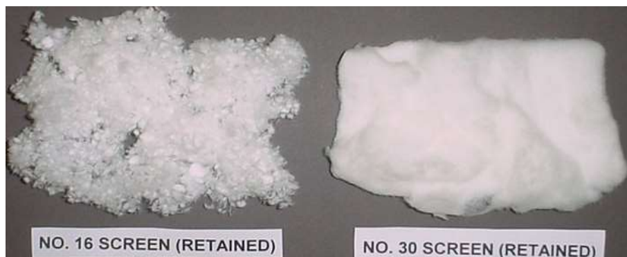
FIGURA 9 – Aspecto de “Nits & Knots” retidos na peneira de 16“ Mesh, e “Good Fluff” retido em peneira de 30” Mesh
