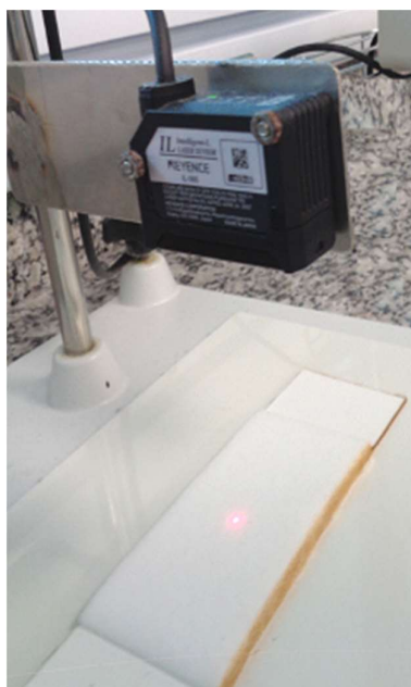
FIGURA 23 – Micrômetro a laser para medição e controle de espessura em corpos de prova
