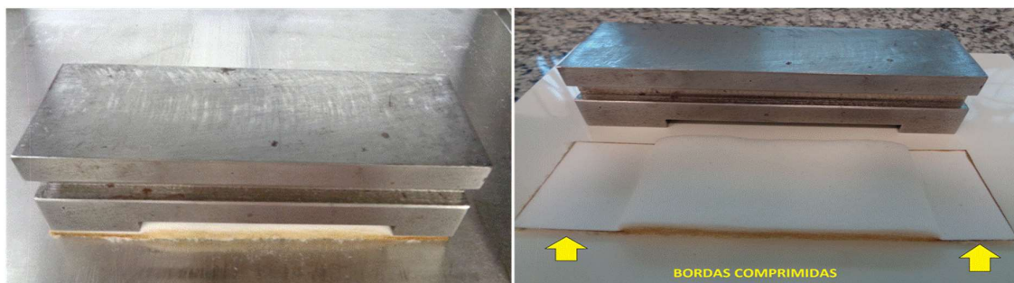
FIGURA 21 – Procedimento de densificação das bordas do corpo de prova utilizando extensor
