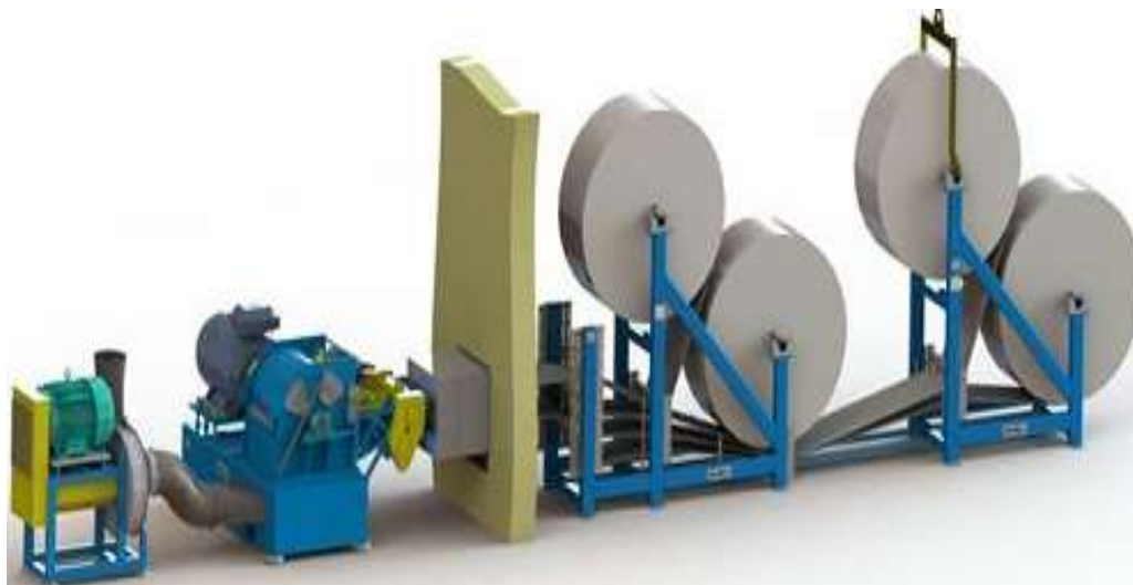
FIGURA 11 – Esquema de alimentação de 4 bobinas de celulose Fluff em um moinho
