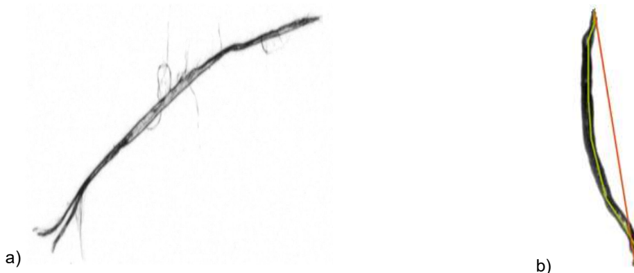
FIGURA 5 – Aspectos morfológicos (a) e princípios de medição (b) para comprimento da fibra celulósica através de microscopia óptica no equipamento FS5 Valmet. Em b, Lc representa o comprimento de linha central (em verde), e Lp representa o comprimento projetado (em vermelho)
