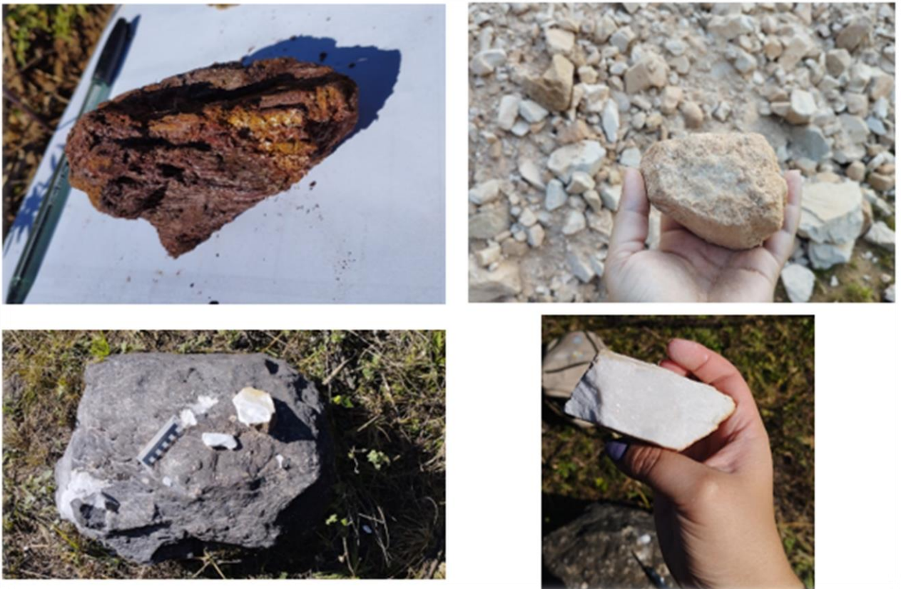
Figura 6 - Rochas metamórficas do Grupo Itaiacoca. (a) xisto; (b) quartzito; (c), (d) mármore dolomítico.
