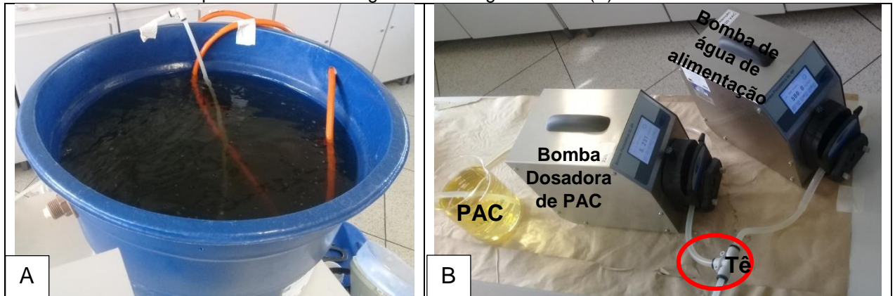
Figura 6: Reservatório de 100L para armazenamento da água salobra antes de ser destinada ao pré-tratamento (A) e recipiente de PAC, bomba de água de alimentação, bomba dosadora de PAC e Tê utilizado para mistura de coagulante com água salobra (B)
